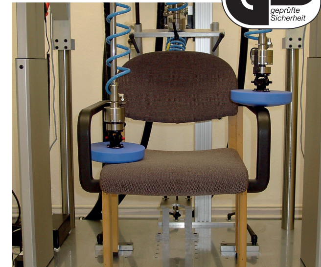
Festigkeitsprüfung einer Armlehne
