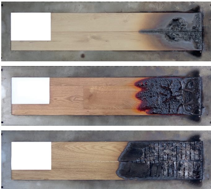
Brandverhalten von Bodenbelägen (Laminat, Elastischer Bodenbelag,
