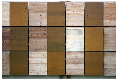
Testfassade mit Mehrschichtplatten
