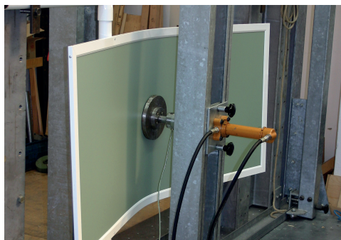
Prüfung einer Balkonbrüstung
