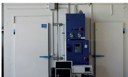
Bestimmung des Wärmedurchgangskoeffizient
