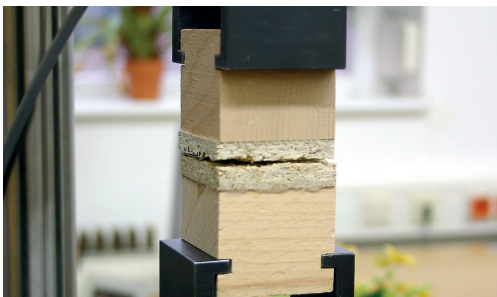
Bestimmung der Querkzugfestigkeit an einer Spanplatte
