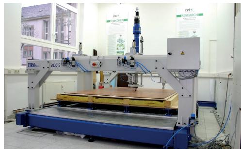
Systemprüfmaschine - Prüfung eines kompletten Deckenaufbaus
