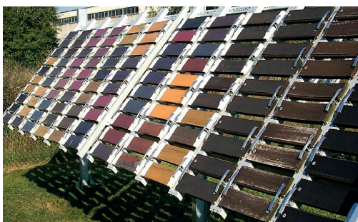
Freibewitterungsprüfstand des IHD/EPH
