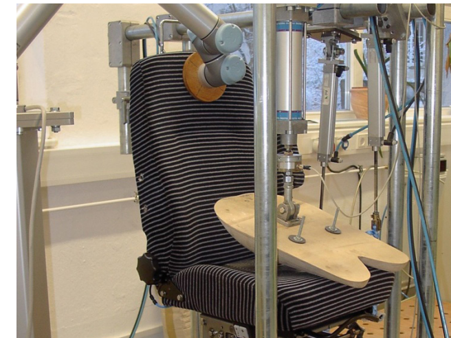
Dauerfunktionsprüfung der Neigungseinstellung an einem Fahrersitz mit Prüfröbter
