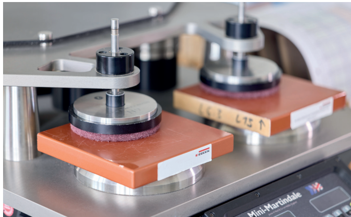
Mikrokratzprüfung mit dem Martindale-Prüfgerät
