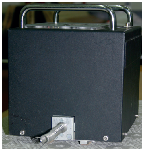
Bestimmung der Rutschfestigkeit eines elastischen Bodenbelages gemäß EN 13893
