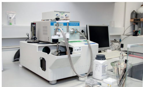
Bestimmung der Glasübergangstemperatur
