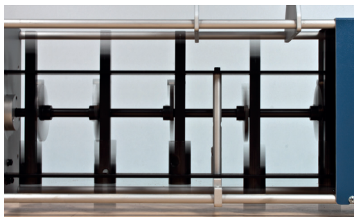
Abb. 4: Normtrittschallhammerwerk zur Schallanregung nach DIN EN ISO 140-8 bzw. DIN EN ISO 10140-5 (Trittschall)
