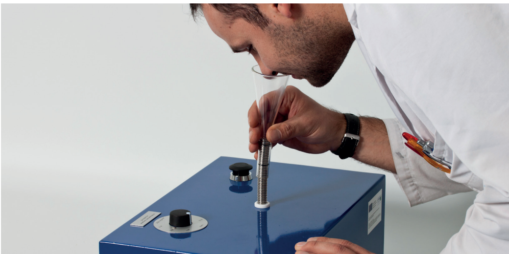
Bestimmung der Geruchsintensität durch Vergleich mit der Referenzsubstanz Aceton
